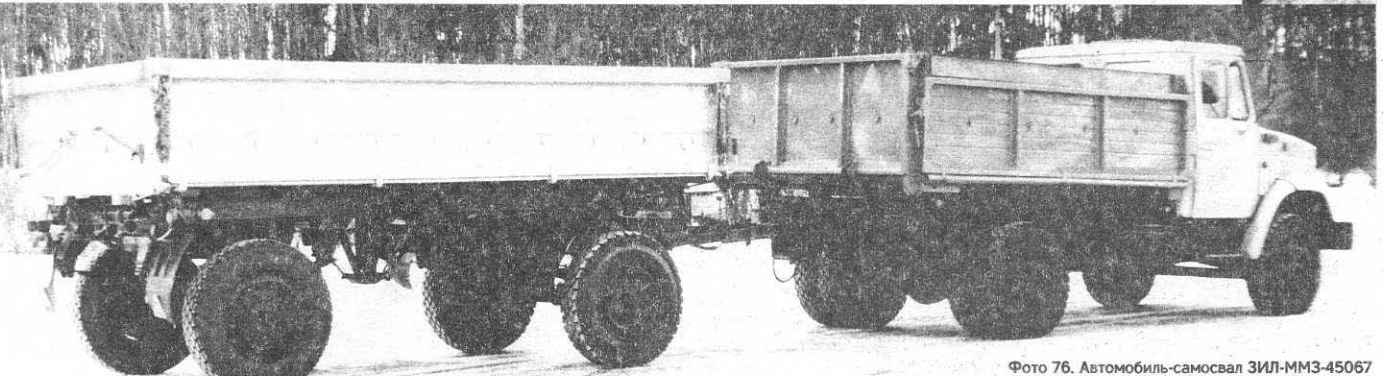
Фото 76. Автомобиль-самосвал ЗИЛ-ММЗ-45067 с самосвальным пиццем ГКБ-819-01
