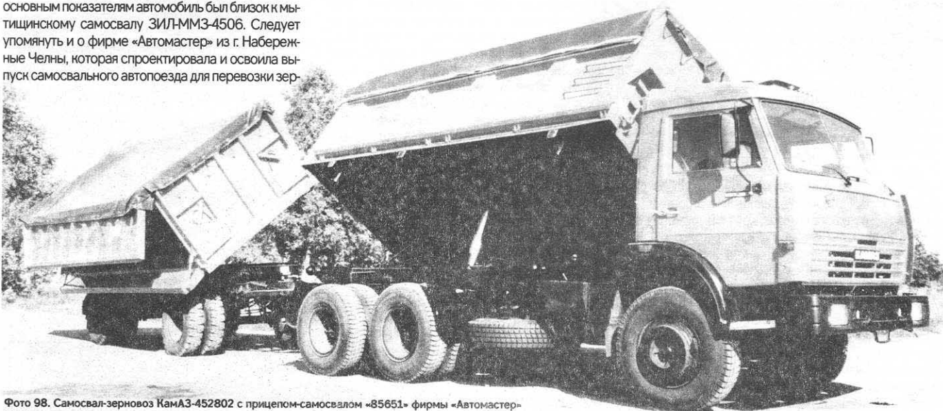
Фото 98. Самосвал-зерновоз КамАЗ-452802 с прицепом-самосвалом «85651» фирмы «Автомастер» (Набережные Челны)
